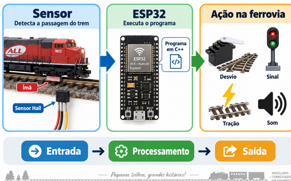
Figura 1 – Fluxo básico da automação: detecção, processamento e ação na ferrovia.
